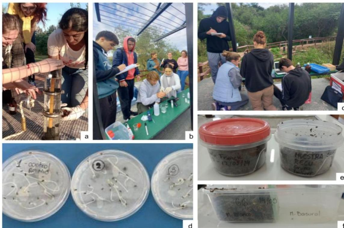
*Figura 2. Algunas actividades realizadas en la práctica de la asignatura QAI: a) toma de muestra de agua; b) y c) medición de parámetros de calidad de agua in situ; d) test de inhibición del crecimiento radicular; e) muestras de suelo y f) test de huida.*
