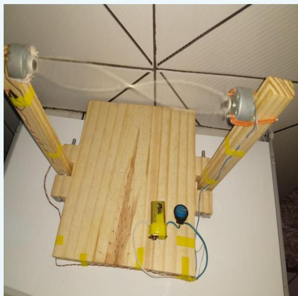
Figura 5 - Gerador de Ondas Estacionárias
