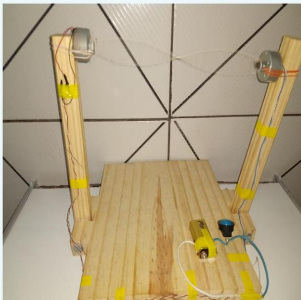
Figura 4 - Gerador de Ondas Estacionárias
